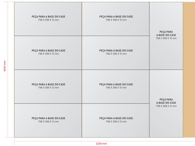
1 chapa de 10 mm de madeira compensado 1 face paricá 2200x1600x10mm para os 4 módulos
